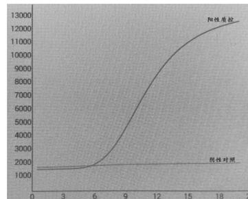
\*阳性质控、阴性对照实时荧光曲线如上示例图（具体以实际曲线为准），所用仪器为先达 GS8 荧光恒温扩增仪。
