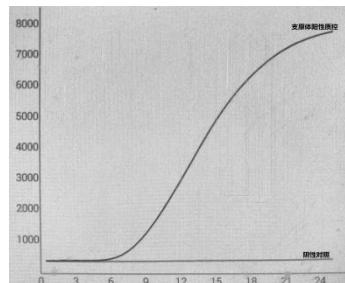
\*支原体阳性质控、阴性对照实时荧光曲线如上右图，所用仪器为先达 GS8 荧光恒温扩增仪。
